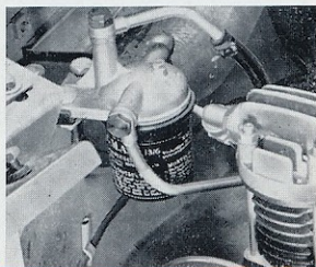
00-21 - Zugang zum Kraftstoff-Filter bei Kurzhauber (Vosges)
