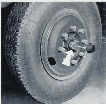
06-12 - Abschmieren der Vorderradnabe - Achse E 250, Chassis VOSGES.
