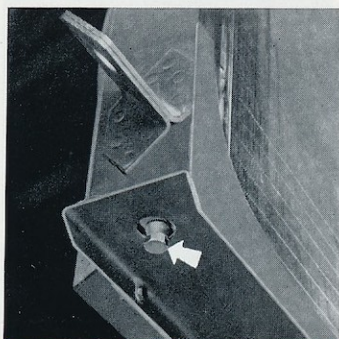
00-30 - Leeren des Kühlers beim Frontlenker VOSGES.
