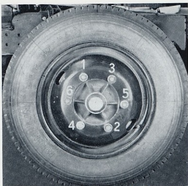
06-9 - Reihenfolge des Anzugs der Radmuttern hinten und vorn (6 Löcher) auf VOSGES.
